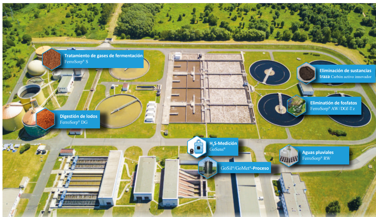
Vista aérea de una planta de tratamiento de aguas residuales, individualizada con posibles aplicaciones de productos de HeGo Biotec GmbH (Fuente: peteri|stock.adobe.com)
