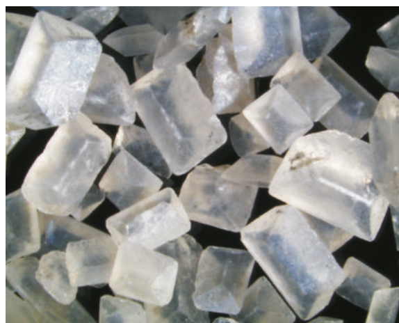
Lichtmikroskopische Aufnahme von MAP-Kristallen
