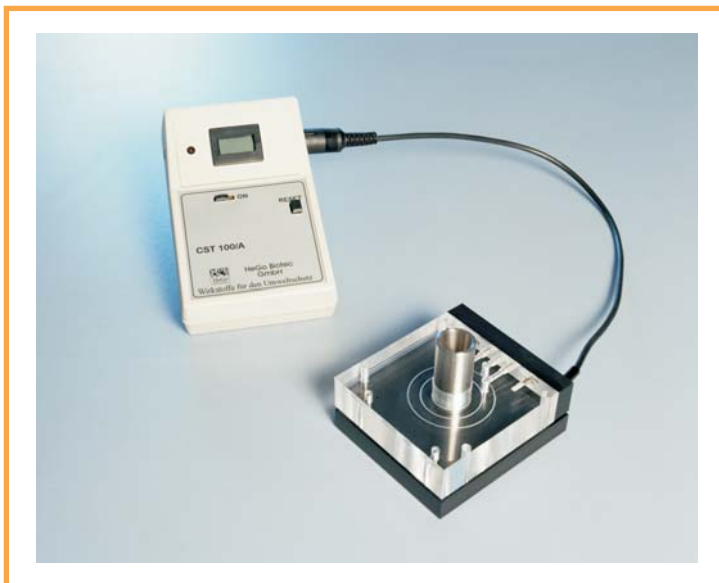
Abb. 1: CST-Gerät, bestehend aus Messgerät und Messplatte
